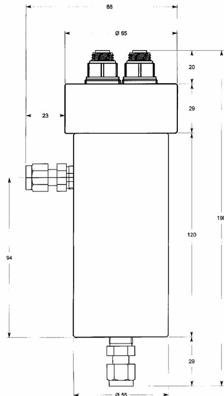
Durchflusszelle mit optionalen Swagelok-Verschraubungen.
