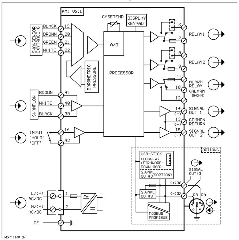
Séparation galvanique des entrées de mesure et des sorties de signaux.
