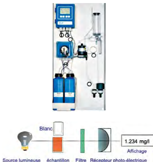
Figure 12 : analyseur d'ozone par spectrophométrie avec son principe de mesure
