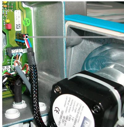
**A** Connettore del motore
